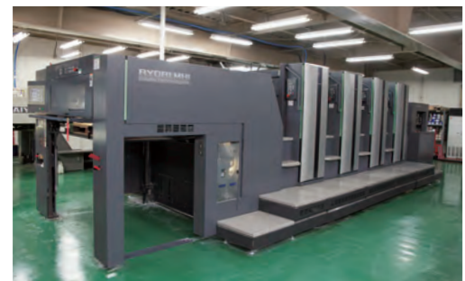
高品質な B1 サイズポスター印刷に対応する RMGT 1050LS-4 モデル
